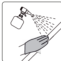
4.3 Reinigen Sie die Oberfläche des Strahlerschutzrohrs mit einem Tuch, um eine hohe UV-Transmission sicherzustellen.
