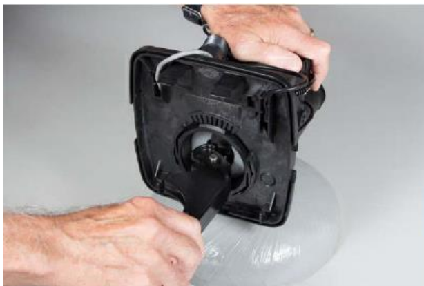
1. INSERIRE L'ESTRATTORE NELLO SPAZIATORE
