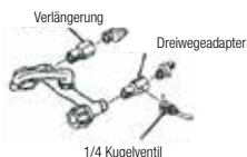
WASSERZUFUSS MIT EINZELBATTERIE
