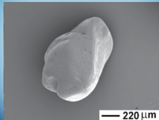
Standard Quarzsand 0,8 - 1,4 mm
