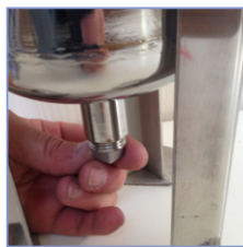
Saída de esgoto 1/2"
