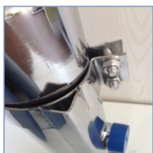
Tôlerie et parois: inox 6 mm
